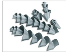
Viele Stähle mit hohen Cr- und Ni-Anteilen können allein durch die Spanbrecher und Spanformer nicht gebrochen werden.
